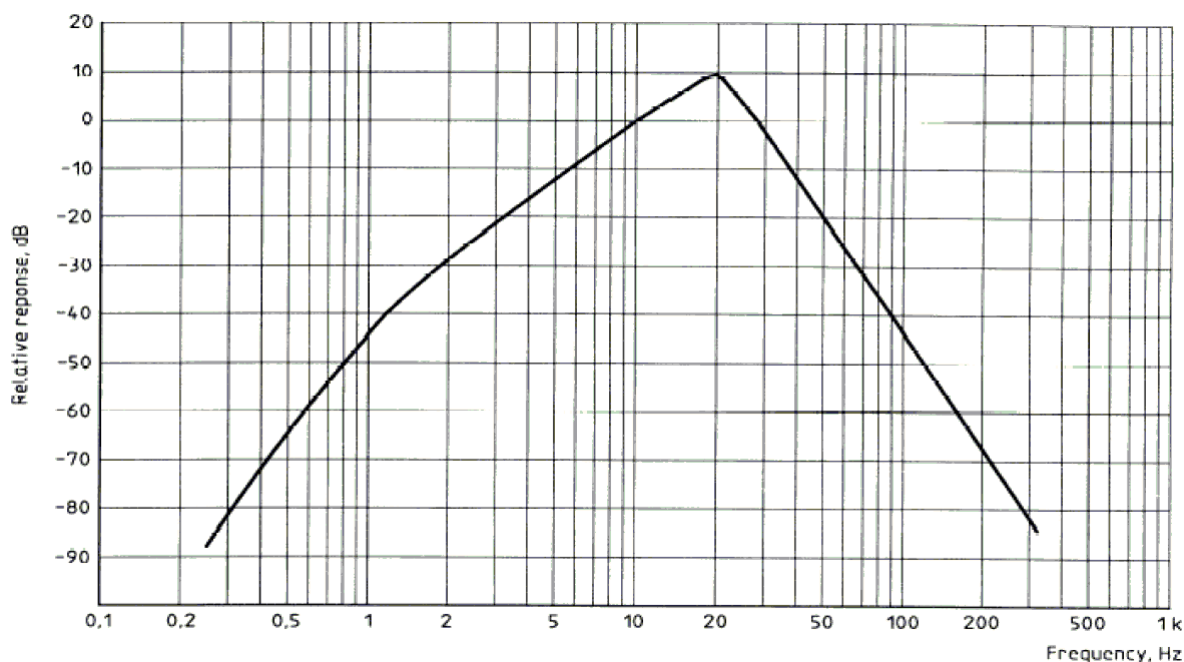
Rys. 3. Krzywa korekcyjna G do pomiaru infradźwięków (logarytmiczna skala częstotliwości). Uwaga: Skala ta uwypukla „hałas” dla 20 Hz i bardzo mocno obcina „hałas” dla częstotliwości niższych i wyższych od 20 Hz.
